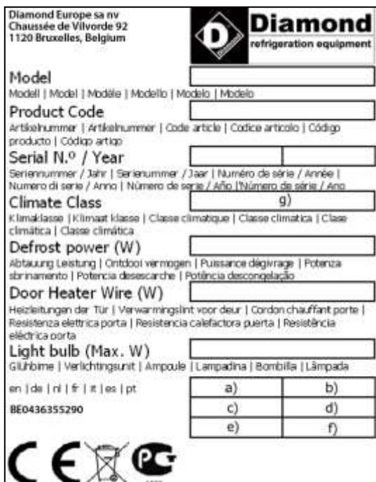
Das Typenschild unserer Geräte befindet sich innerhalb des Geräts, auf der Linkeninnen Wand. Hier finden Sie die wichtigsten technischen Daten der Anlage und die Identifizierung des MODELLS und der SERIENNUMMER. Letztere sind für irgendwelche Nachfragen beim Hersteller notwendig.
