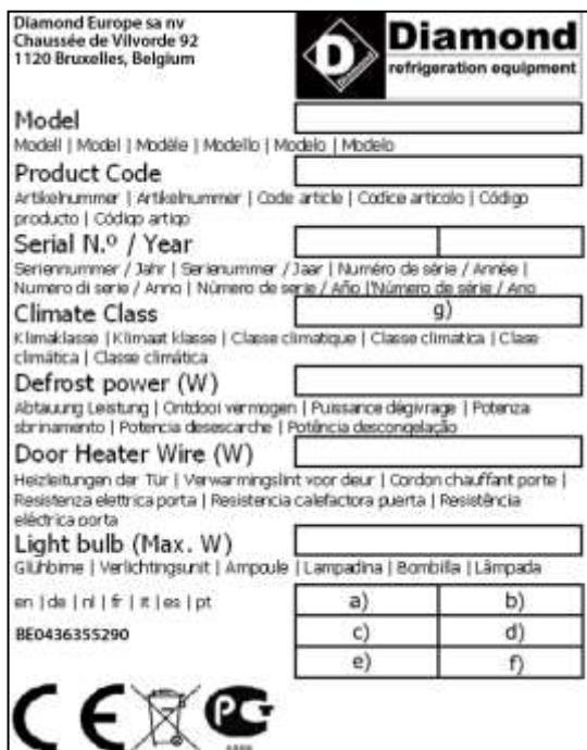
La placa de características de nuestros equipos está colocada en el interior de la máquina, en el panel del lado izquierdo. En ella encontrará los principales datos técnicos del equipamiento y la identificación del MODELO y el N.º de SERIE, fundamentales para cualquier consulta al fabricante.
